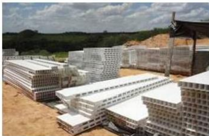
FIGURA 10 – Painéis de PVC pré-moldados na fábrica
